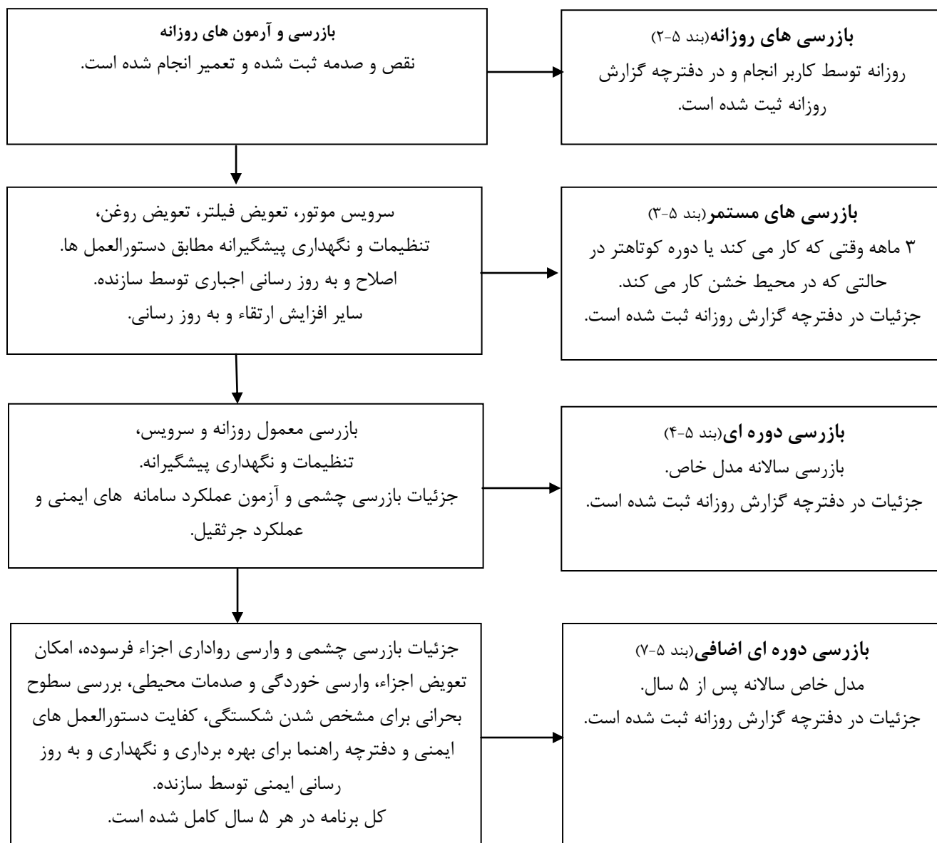
شکل ب-۲- جرثقیل با کمتر از ۵ سال کار و دستورالعمل ها موجود نبوده یا توسط فرد باصلاحیت ناکافی و نامناسب تشخیص داده شده است
