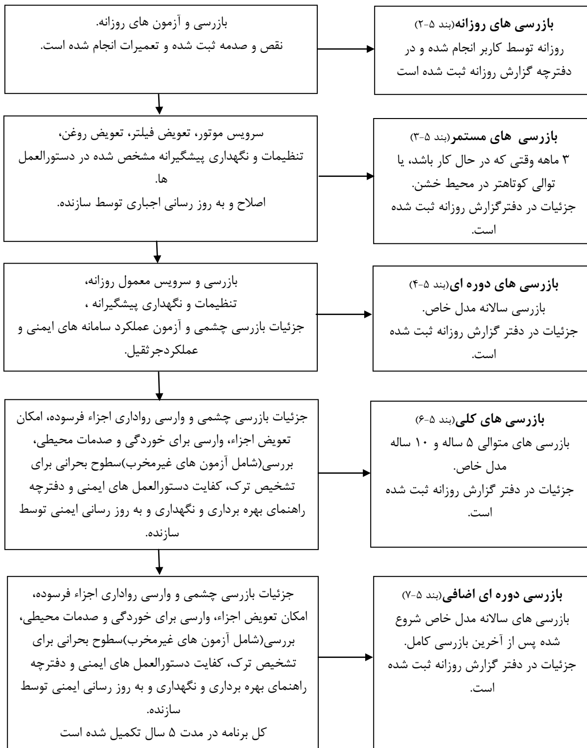
شکل ب-۳- جرثقیل با بیش از ۵ سال کار و دستورالعمل ها موجود نبوده یا توسط فرد باصلاحیت ناکافی و نامناسب تشخیص داده شده است و بازرسی دوره ای اضافی پذیرفته شده است
