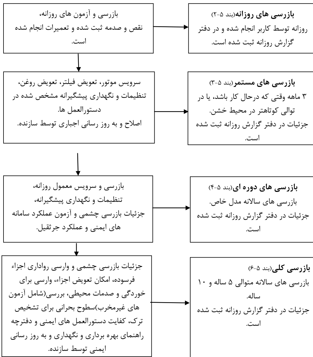
شکل ب-۴- جرثقیل با بیش از ۵ سال کار و دستورالعمل ها موجود نبوده یا توسط فرد باصلاحیت ناکافی و نامناسب تشخیص داده شده است و بازرسی اجزاء بحرانی ترجیحاً ۱۰ ساله
